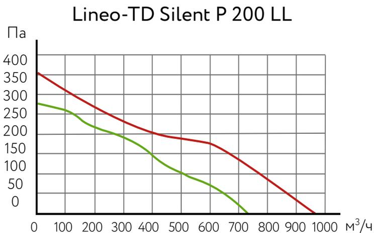
Данные аэродинамических характеристик приведены для температуры сухого воздуха 20°C и атмосферного давления 760 мм.рт.ст.
