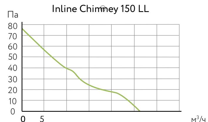
Данные аэродинамических характеристик приведены для температуры сухого воздуха 20°C и атмосферного давления 760 мм.рт.ст.
