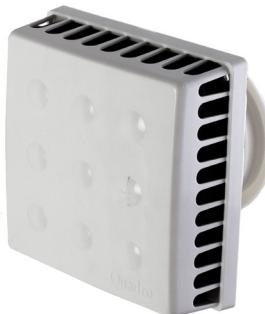
Патрубок клапана с силиконовым уплотнителем продевается через квадратную уплотнительную прокладку, плотно вводится в трубу и фиксируется к стене с помощью 4-х шурупов. Узел регулировки позволяет регулировать степень открытия/закрытия заслонки при помощи утопленного колесика на корпусе или шнура.
